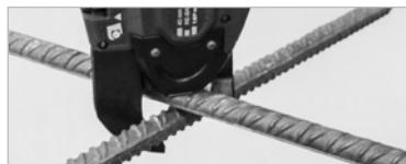
**2.** Placer le bec perpendiculairement au ferraillage au niveau de l'intersection des armatures à lier et centrer le bec sur l'armature. Mettre le bec en appui sur les armatures.
