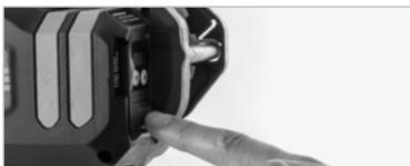
**11.** Ajustement du couple de serrage. Le chiffre à gauche de l'afficheur indique le nombre de tour autour de l'armature. (Voir paragraphe ci-dessus). Le nombre de droite indique le réglage du couple de serrage. Plus le chiffre est élevé, plus le couple est élevé. Pour augmenter appuyer sur le bouton ⚡ pour diminuer appuyer sur le bouton ⚡. Nous recommandons :
