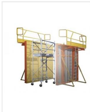
Le Junior Banche est un escalier en acier galvanisé avec un plancher de 136 x 54 cm. Ses cadres ouverts, son accès par échelle latérale et son dimensionnement le rendent particulièrement adapté au travail dans les banches. De plus, ses anneaux de grutage intégrés permettront un déplacement aisé.
