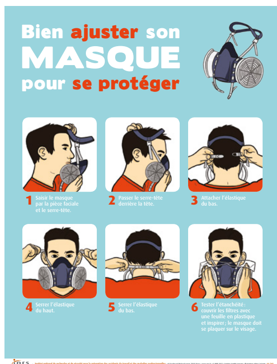
Figure 2. Contrôle d'étanchéité à pression négative
