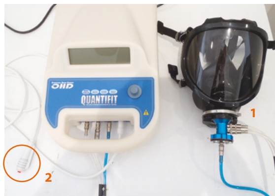
Figure 1. Description du montage pour la réalisation de l'essai d'ajustement au Quantifit 1. adaptateur, 2. bouton déclencheur du test.
