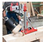
Carottage dans les planchers CLT ou bois massif pour le passage de tuyaux d'évacuation, ventilation, chauffage... Carottes spécifiques bois. Excellente qualité de finition de la surface du trou de forage
