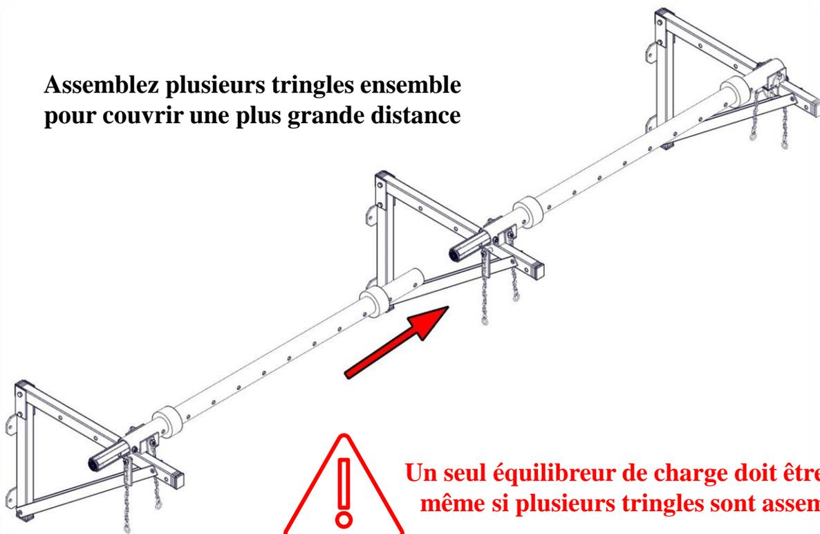
**Un seul équilibreur de charge doit être utilisé, même si plusieurs tringles sont assemblées.**
