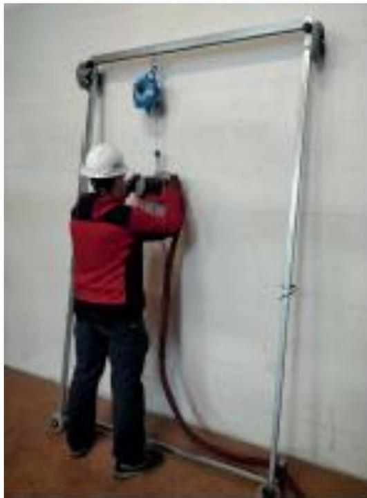
*Solution complète pour le ponçage industriel de murs permettant de limiter les contraintes posturales et de port de l'outil.*
