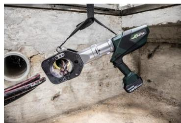
*Coupe câble à guillotine Ø105mm - coupe à distance avec télécommande pour le réseau BT*
