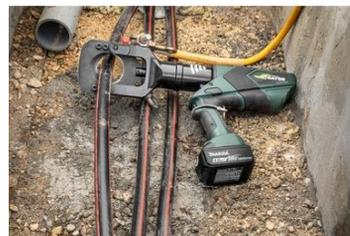
*Coupe câble à guillotine Ø65mm - coupe à distance avec télécommande pour le réseau BT*
