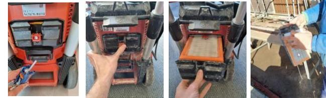
⚠ Prévoir clé 6 pans 5mm pour ouvrir / verrouiller cassette à filtre. Indique au collaborateur qu'il va entrer en contact avec de la poussière de silice.
