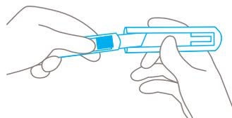
Lors de l'insertion, ne pas placer la main dans la zone de sortie de la lame !
