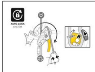
Le système AUTO-LOCK permet de se positionner facilement au poste de travail, sans avoir à manipuler la poignée et à réaliser de clé d'arrêt : dès que l'utilisateur relâche la poignée, la corde est automatiquement bloquée dans l'appareil.
