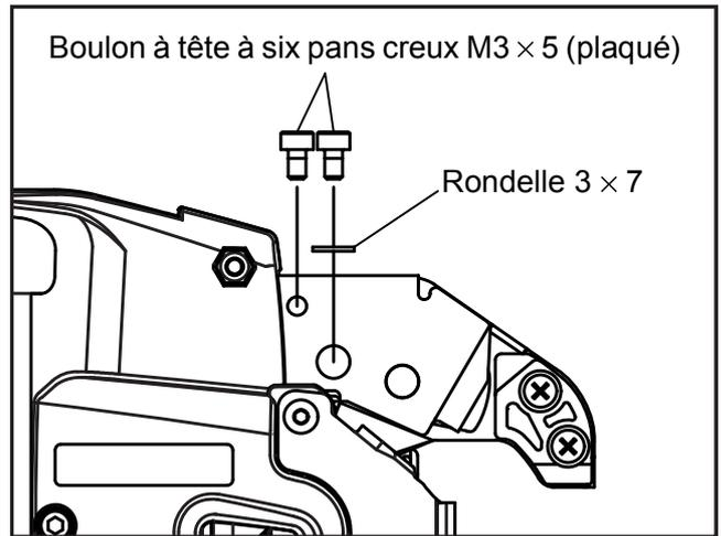
5. Assurez-vous que le bras B est assemblé correctement et serrez les deux boulons à tête à six pans creux M3 x 5 (plaqués). (Couple de serrage : 172 cN·m (15,2lbF·inch))
