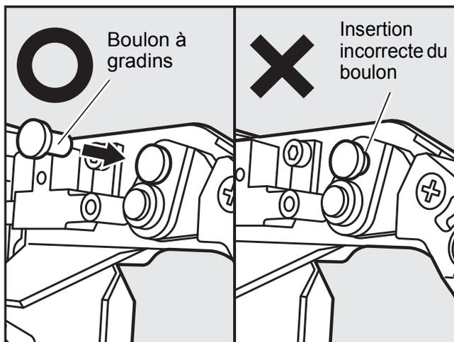
4. Insérez le boulon à gradins dans le trou, puis dans le trou de la bielle de connexion.
