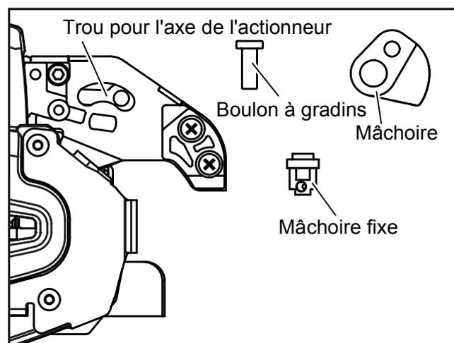
3. Retirez les mâchoires (fixe et mobile) et nettoyez-les. (Les pièces démontables sont : la mâchoire fixe, la mâchoire mobile et le boulon à gradins.)
