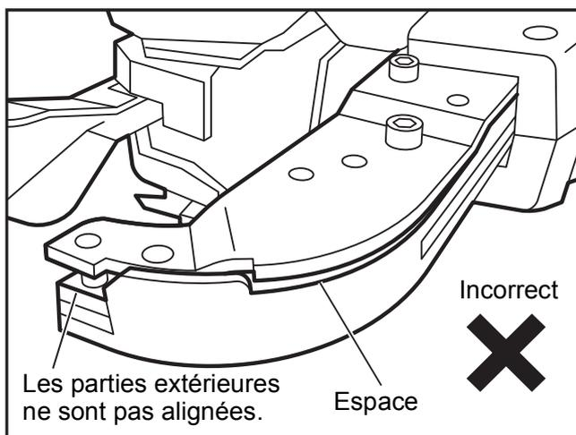
7. Assurez-vous que le bras B est assemblé correctement et serrez les deux boulons à tête à six pans creux M3 x 6 (plaqués). (Couple de serrage : 172 cN·m (15,2lbF·inch))
