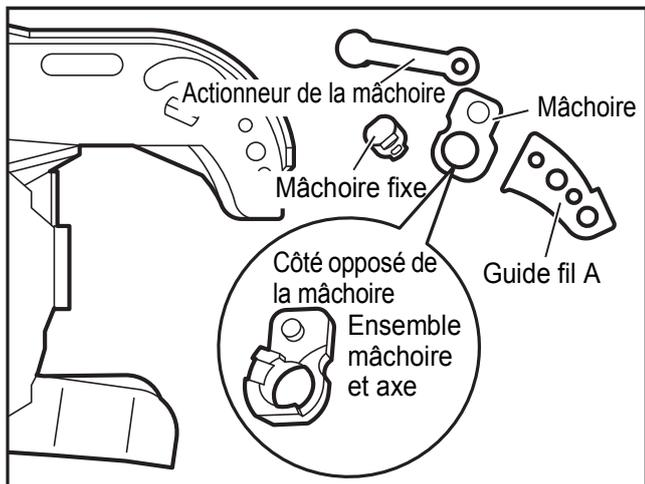
3. Retirez les mâchoires (fixe et mobile) et nettoyez-les. (Les pièces démontables sont : la mâchoire fixe, la mâchoire mobile, le guide fil A et l'actionneur de la mâchoire.)
