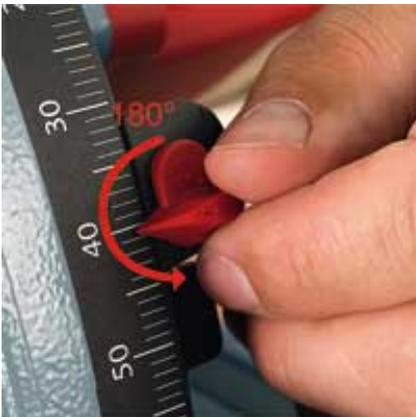
Avec ou sans règle de guidage - la bonne profondeur de coupe sera toujours visible en tournant simplement l'indicateur de coupe.
