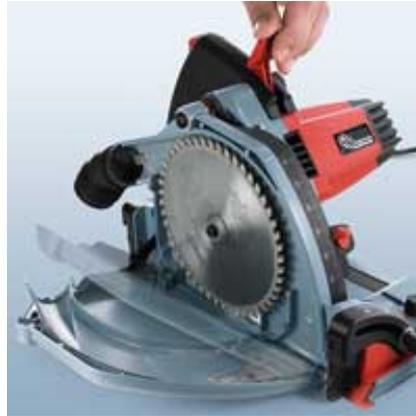
Le changement de la lame de scie le plus rapide au monde: appuyez simplement sur le bouton de déverrouillage et relevez le levier. Le carter s'ouvre et la lame peut être changée en un tour de main et surtout sans endommager les dents de la lame.
