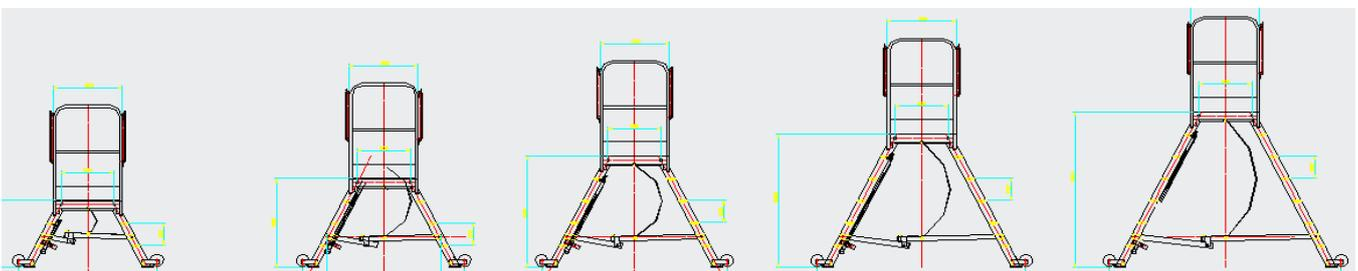
Structure aluminium. Accès des deux cotés par marches striées profondeur 80mm largeur 430mm
