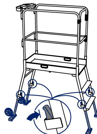
**7** Régler les 4 pieds de la plate-forme à la hauteur souhaitée. La sortie est automatique. Pour rentrer les pieds, appuyer sur les verrous d'un piétement, et accompagner la descente de la plate-forme jusqu'au verrouillage.
