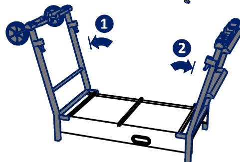
**2** Ouvrir les piétements de support 1 puis de montée 2, jusqu'en butée.
