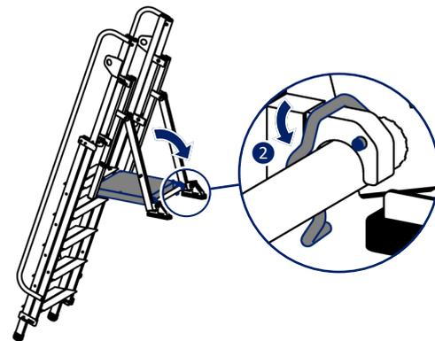
**2** Pivoter l'appui réglable et verrouiller les 2 crochets **2** sur le barreau.
