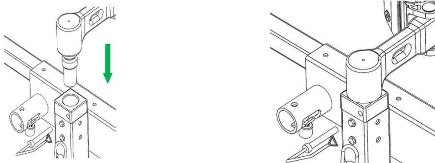
Repositionner la broche de sécurité et la verrouiller.
