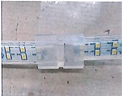
4 - Planter les picots du raccord de réparation dans les deux parties du ruban à abouter\*
