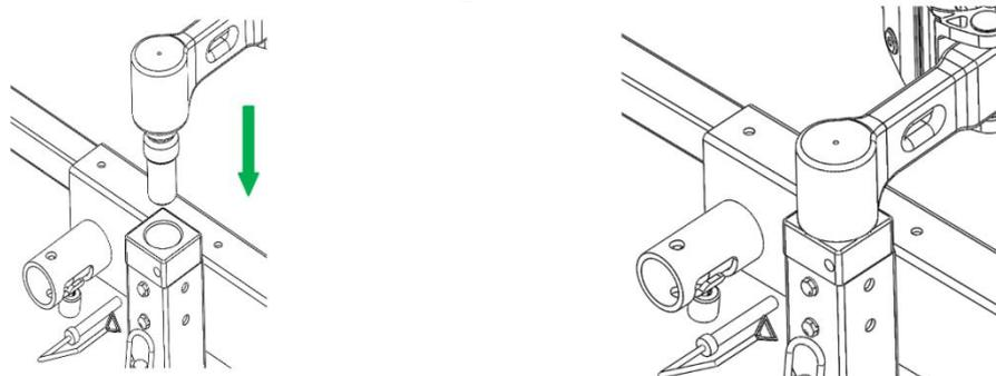
Repositionner la broche de sécurité et la verrouiller.
