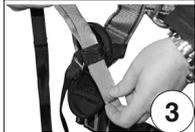
**DE - 1** Das Ende des Gurts (mit Schlaufe) aus dem Etui ziehen und dieses Ende im Bereich der Taille hinter dem Gurtband des Auffanggurtes durchführen.
