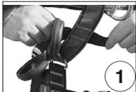
**FR - 1** Dégager l'extrémité de la sangle (avec boucle) de l'étui et passer cette extrémité derrière la sangle du harnais au niveau de la taille.
